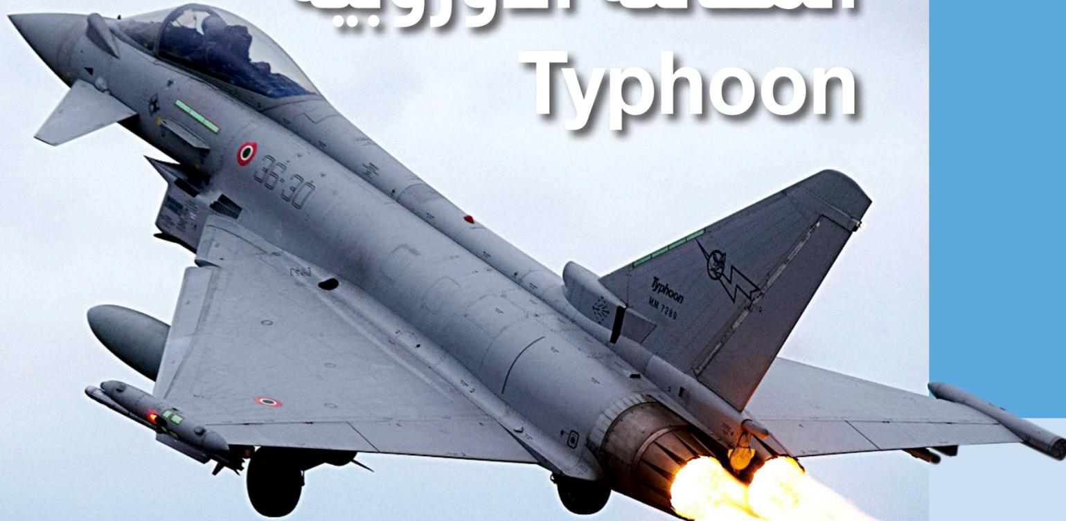
يمنحها قدرة عالية على المناورة حيث تعتمد الطائرة على الهيكل غير المستقر إيروديناميكا وتحقيق الاستقرار المطلوب عن طريق أنظمة الطيران السلبي الحاسوبي الرقمي. أجنحة المقاتلة من النوع «المثلث» -دلتا- المصنوع من المواد المركبة في معظمه، واستخدم في صناعة الهيكل والجناح مواد الكربون المركب والبلاستيك الزجاجي المقوى والتيتانيوم والألومنيوم، تستخدم جنيحات التقلب الأمامية للمساهمة في تحقيق زوايا مناورة فائقة.
